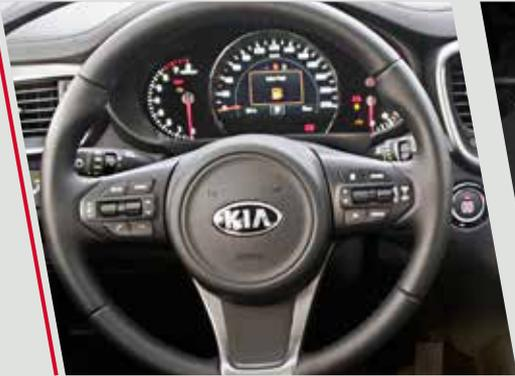
Volante multifuncional com regulagem de altura e profundidade, piloto automático, controle do sistema de som, Bluetooth e computador de bordo. Além do botão Start/Stop e chave Smart Key.
